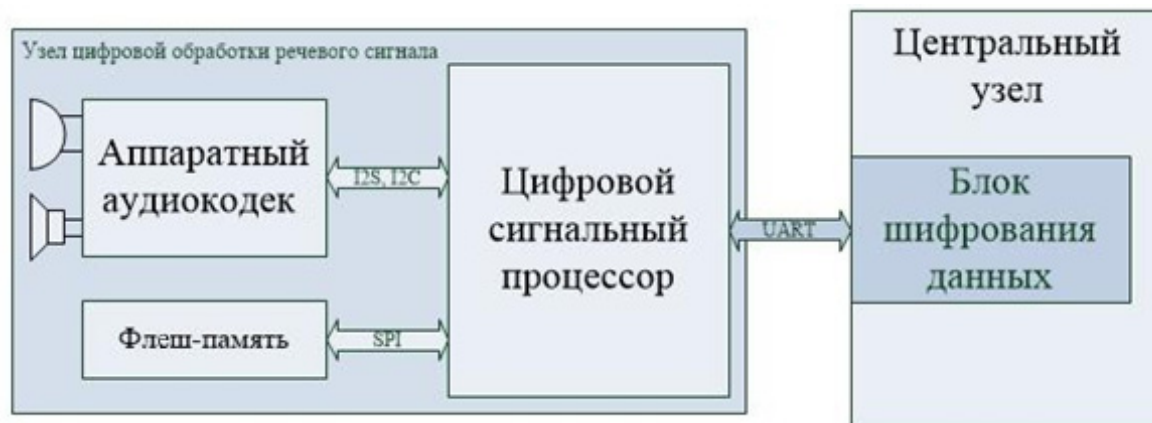
Рис. 2. Функциональная схема узла цифровой обработки речевого сигнала
