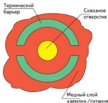
Рис. 2. Термическая разгрузка
