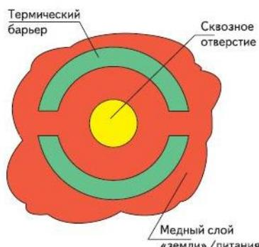
Рис. 2. Термическая разгрузка
